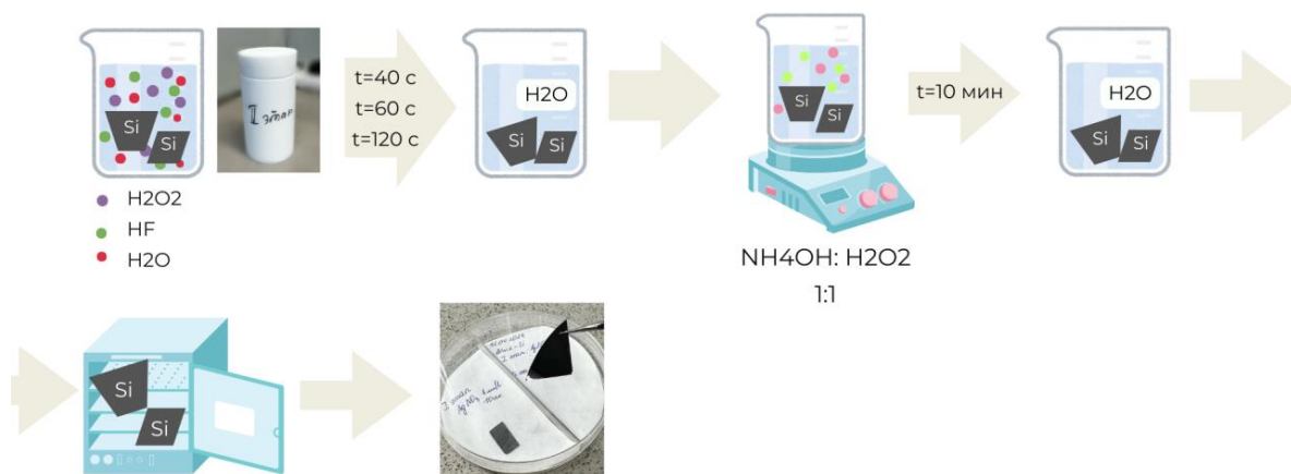
24 сурет- Химиялық жемірілу процессінің 2 кезеңінің жүру механизмі
