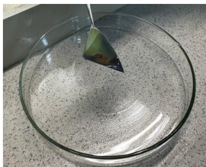
23 сурет- Ag нанобөлшектерінің төсеніш бетінде қалыптасуы
